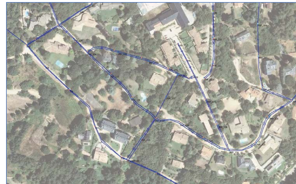
Figura 1. Funcionament de la xarxa per a pluja de T=10 anys. En blau, la xarxa que funciona en làmina lliure. En vermell, xarxa que funciona en pressió.
