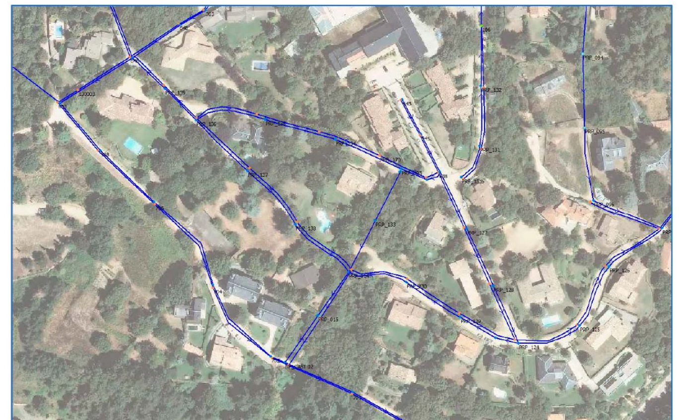
Figura 3. Funcionament de la xarxa per a pluja de T=10 anys. En blau, la xarxa que funciona en làmina lliure. En vermell, xarxa que funciona en pressió.
